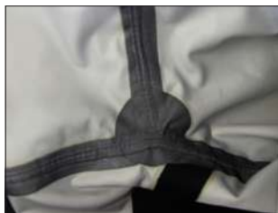
Wewnętrznie klejone i wzmocnione szwy
